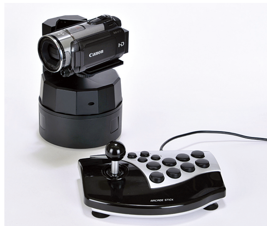
写真2 USB接続の汎用ゲームコントローラーと接続して制御できるようになった
