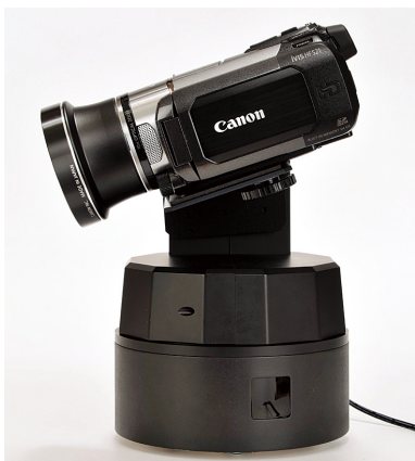
写真3 カメラの重心に注意して取り付け
