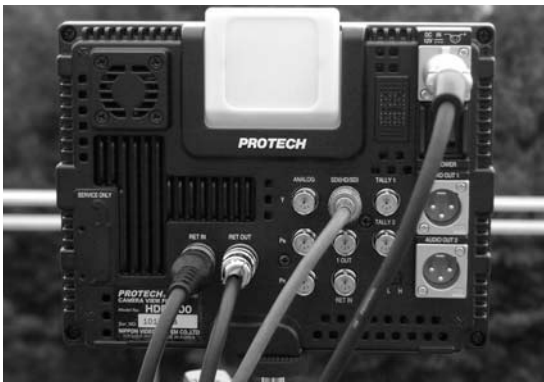
写真3 タリーランプは背面にも装備されている
