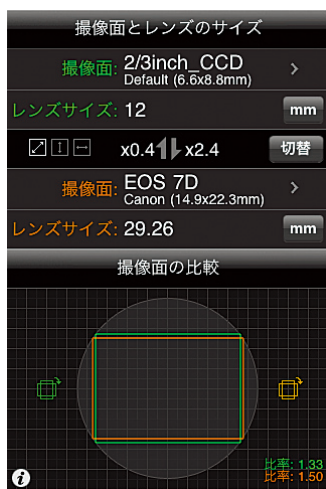
写真2 2/3型CCDのビデオカメラ+12mmレンズで仮撮影し、本番はキヤノンEOS 7Dの場合、使用焦点距離は29.26mmと表示された
